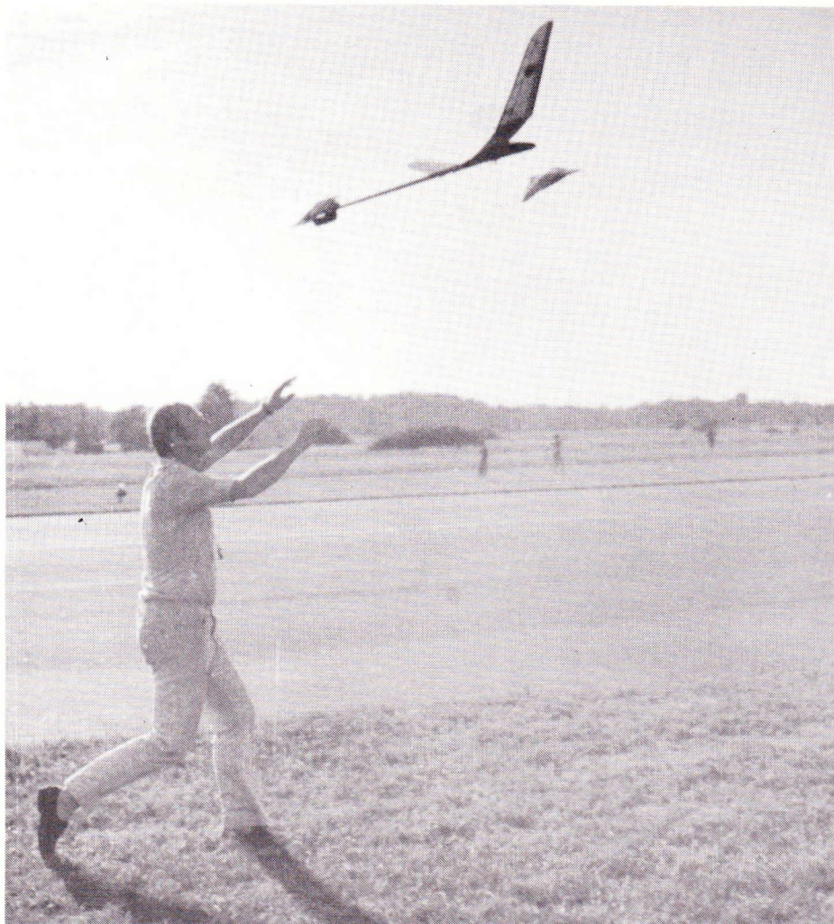
Start af en svævemodel. En hjælper slipper modellen, og den trækkes op med en 50 meter lang højstartslinje.
