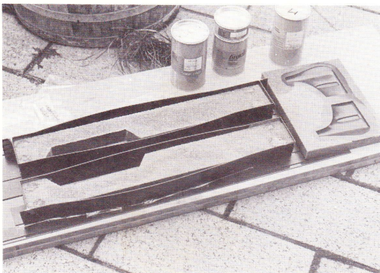
Støbesand er påfyldt for-kropformen. Haleformen er færdig.
