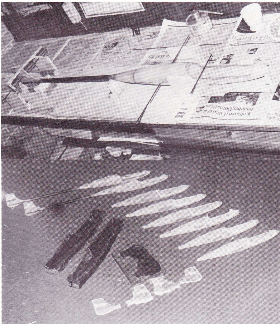
Øverst ses Knud Hammekens »jig« til nøjagtig samling af UNICA-kroppen. Nederst kroppe og haler på forskellige stadier vist sammen med formene.
