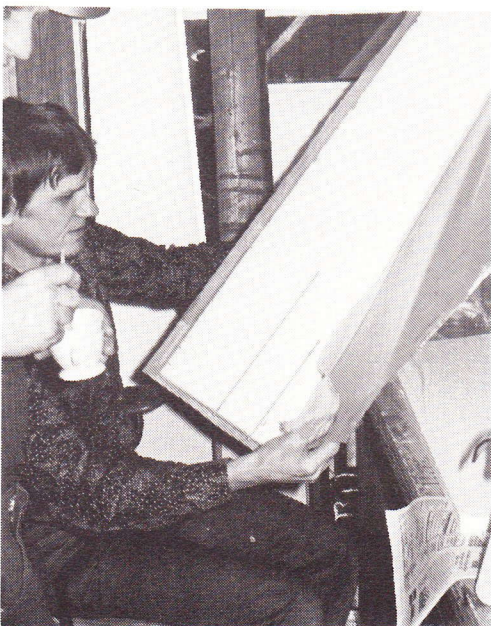
Efter at glas-epoxybeklædningen er fastgjort på undersiden af vingen, fastklæbes det under tryk til oversiden, ligeledes med epoxy.
