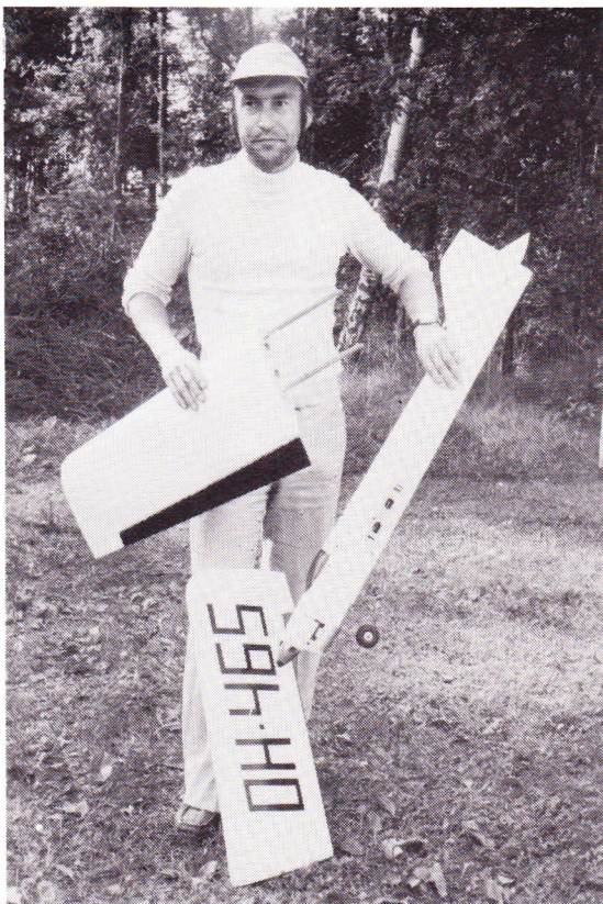
Kai Karma fra Finland blev nr. 4 i kunstflyvning med denne model ved NM i Ålborg. Modellen er særpræget i sin opbygning og har balsabeklædte skumvinger med to I-formede aluminiumsprofiler, hvormed vinger og krop samles. Modellen er forsynet med en HP 40 motor, som driver en 4-bladet propel.
