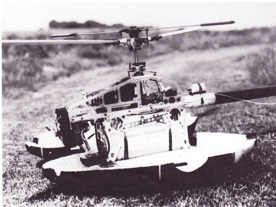
Her ses helikopterens krop i »nøgen« tilstand. Det ses, hvordan hele strukturen er lettet overalt, hvor det er muligt. Motoren er en HB 61, mens radioanlægget er et Robbe Mars FMM Rex.
