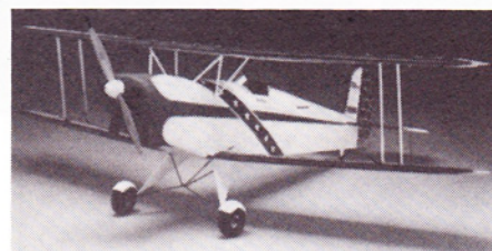
Pilot Bücker Jungmann, spændvidde 2,1 m, vægt ca. 6 kg. Motor fra 15 cm 3 .
