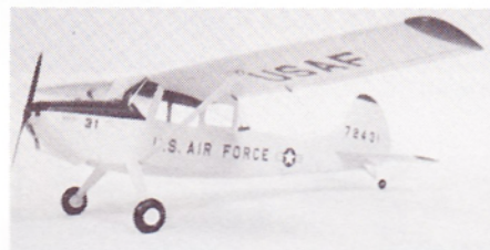
Pilot O-1E Bird Dog, spændvidde 2,2 m, vægt ca. 6 kg. Motor fra 10 cm 3 .
