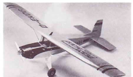
Multiplex Big-Lift, spændvidde 2,22 m, vægt ca. 3,6 kg. Kan lastes med ca. 2,5 kg. Motor fra 10 cm 3 .
