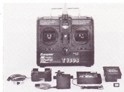
Graupner/JR T1008 FMss, 27, 35 el. 40 MHz, udskifteligt sendermodul, 4 kanaler.
