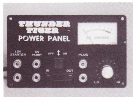
Thunder Tiger Power-Panel. 6 V pumpe tilslutning kan ændres til 12 V.
