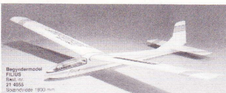
Multiplex Filius , spv. 1800 mm, trækkrop og balsavinge.
