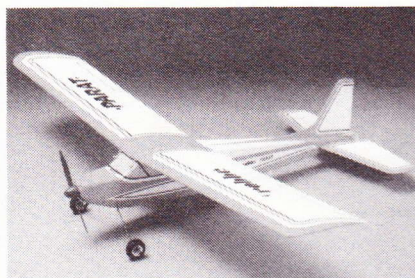
Robbe Elektro-Parat, spv. 1285 mm, trækkrop og ribbevinger. Byggesættet indeholder el-motor.
