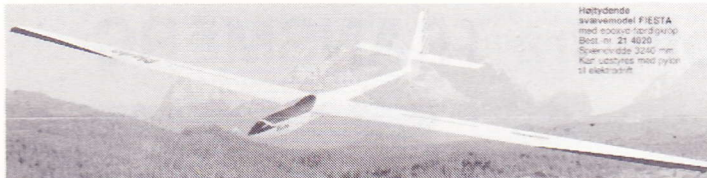
Multiplex Fiesta , spv. 3240 mm, glasfiberkrop og ribbevinger.
