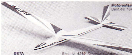
Graupner Beta , spv. 1970 mm, trækkrop og ribbevinger.
