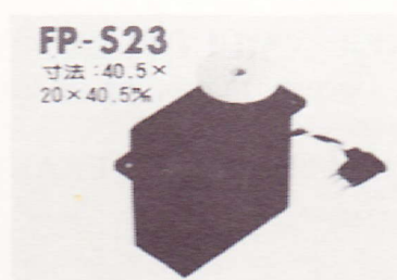
FUTABA FP-S23 Normal mini-servo. Mål: 40,5 × 20 × 40,5 mm. Vægt: 47 gram. Trækraft: 3,2 kg/cm.
