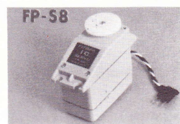
FUTABA FP-S8 Servo til understel. Mål: 44 × 23 × 41 mm. Vægt: 50 gram. Trækraft: 8 kg/cm.
