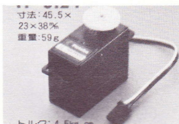
FUTABA FP-S24/124 Nyhed — servo med trådløs motor. Mål: 45,5 × 23 × 38 mm. Vægt: 59 gram. Trækraft: 4,5 kg/cm.
