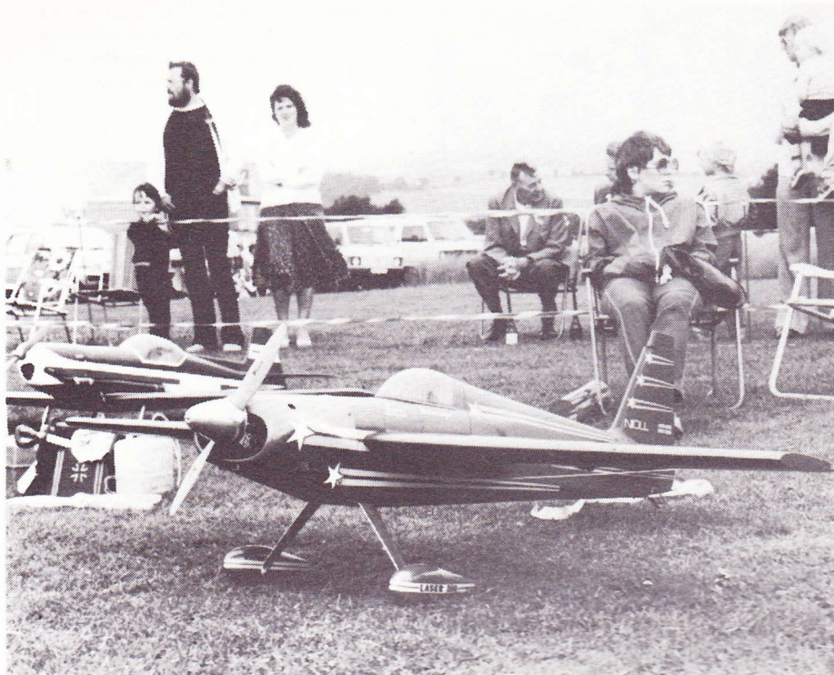
Herover ses motorinstallationen i en Yak 50 — det er en Bully 45 benzinmotor på 45 cm 3 . Til venstre den »lille« udgave af Laser 200 fra Topp Modelle. Spændvidde 2 meter. Motoren er en Quadra med almindelig dæmper, og vægten ligger på 6 kg.
