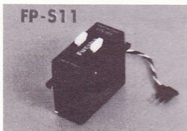
FUTABA FP-S11 Servo med lineart udtag. Mål: 38 × 20 × 45 mm. Vægt: 40 gram. Trækraft: 2,3 kg/cm.
