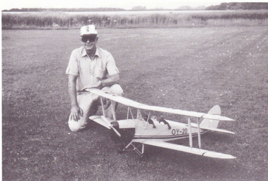
ESBJERG MODELFLYVEKLUB har fået ny formand, Egon Schmidt, som her ses med sin Tiger Moth. Modellen er 1,8 m i spændvidde og vejer nær 4 kg. Den trækkes af en OS 10 cm 3 fir-takter. Tak til Anders Torbensen for billedet.
