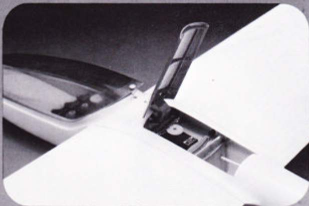
Kabinen kan let åbnes. Bremseklappen ses i opslået stilling.
