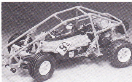
Robbe Romax Expert Længde 520 mm. Motor 3,5-4 cm 3 . Uafhængig hjulaffjedring med olie- støddæmpere.
