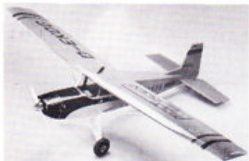
Multiplex Big Lift. Spændvidde 2.225 mm. Motor 10 cm 3 . Stormodel til flyslæb, løft mv. Opsats findes.
