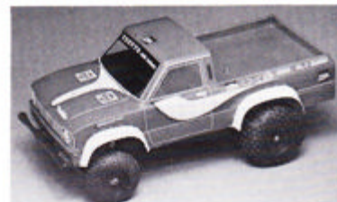
Robbe Toyota Hilux. Længde 410 mm. Kobling, gearkasse, fartregulator. Motor 7,2 V.
