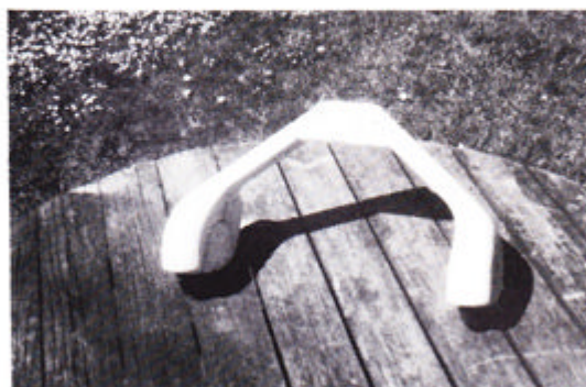
Her er det understellet fotograferet inden det er slebet til i den rigtige facon. Det hele er beklædt med blødt balsa, så den helt rigtige form let kan opnås ved flittig brug af kniv og sandpapir.
