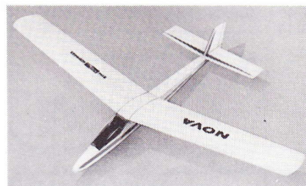
Nova svævemodel. Spændvidde 905 mm. Vægt uden RC-anlæg ca. 165 gram.
