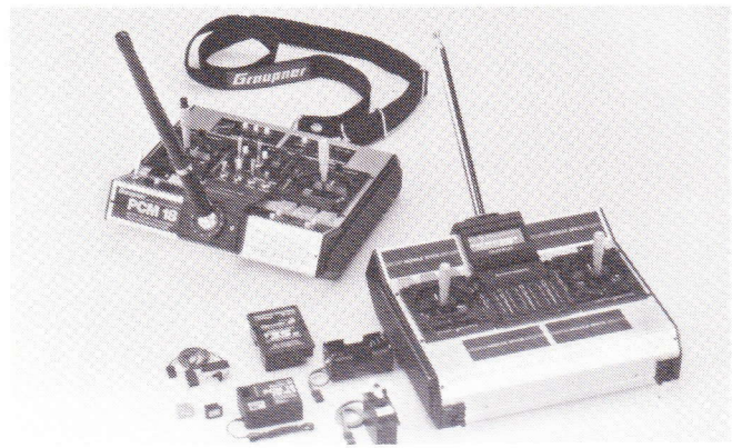
Til venstre i billedet ses FM 6014/PCM 18 senderen udbygget med moduler og med kort specialantenne. Til højre ses senderen i grundudførelsen med placeringsmuligheder til moduler øverst og nederst på senderoversiden og mellem styrepindene.
