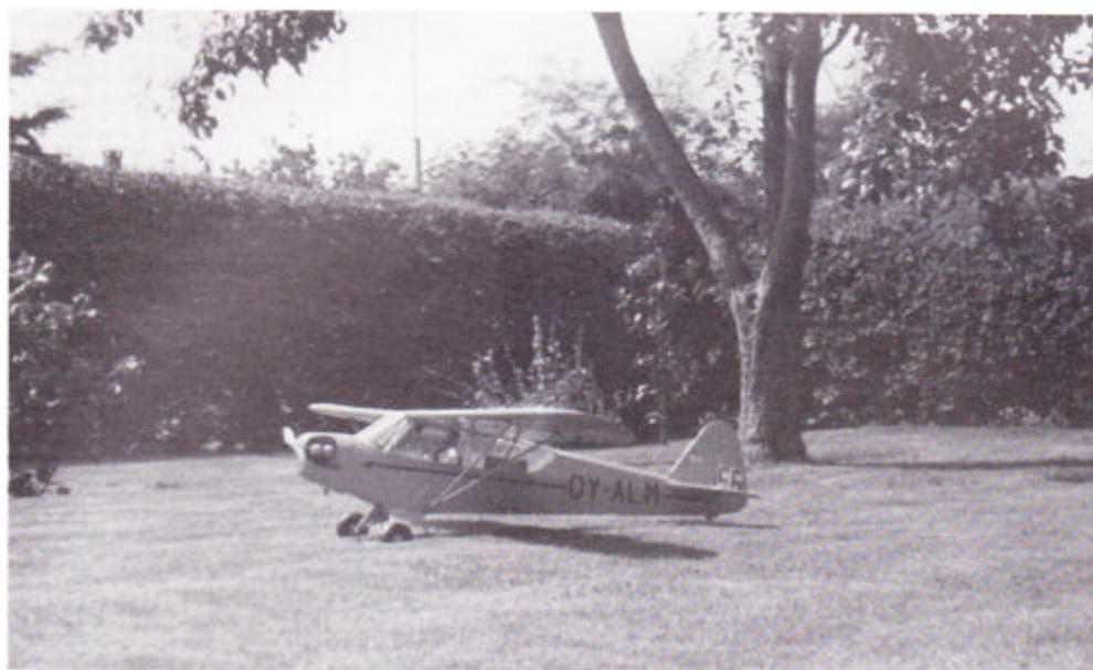
En glimrende model til Dan-skala. Det er Finn Rasmussen selv, der har bygget denne Piper Cub J-3 skala 1:6 ud fra et Svenson-byggesæt. Modellens spændvidde er 180 cm, den vejer 2,0 kg og trækkes af en standard OS-20. Propellen, der driver hele herligheden er en 10x4".
