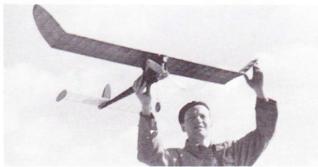
Carl Johan Petersen — »Calle« — med en smuk motormodel fra 1948, »Calle 16 d«. Det var Danmarks første velflyvende gasser, som kunne opnå flyvetider over 180 sek. med »kun« 30 sek. motortid. Motoren var en Thorning III 2,5 cm 3 diesel.
