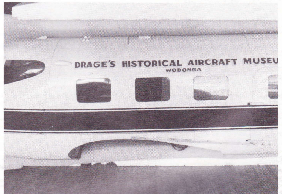
Kropssiden, hvor man især skal hæfte sig ved den lange skinne til venstre for døren. På den skrues vingefairings til krop og vinge med bitte små skruer, Dave har drejet. Se også bogstaverne!
