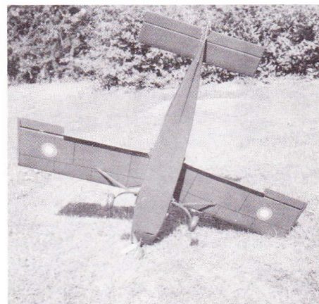
T-17 fra undersiden. Trods modellens lidenhed er der ingen udvendige horn eller trækstænger. Forhjulet er selvfølgelig styrbart med teleskopaffjedring, hvorimod hovedstellet er torsionsaffjedret.
