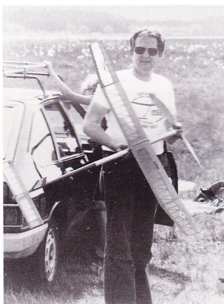
Erik Knudsen har forsynet denne wakefield med forkropsrør af aluminium.
