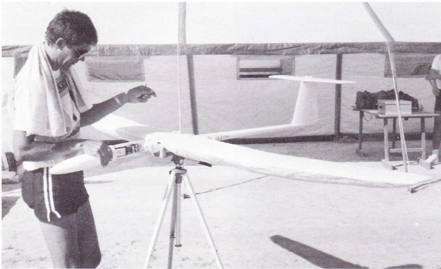
Mesteren Reinhard Liese selv med sin Epsilon — længe før han selv troede på sejren. Ballaststave monteres langsgående i kroppens centersektion, så vingerne ikke skal afmonteres for omballastering.
