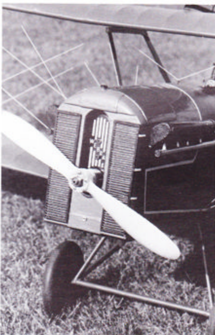
Næsedetaljer - bemærk den hjemmelavede propelskive, som bidrager til veteran-udseendet.
