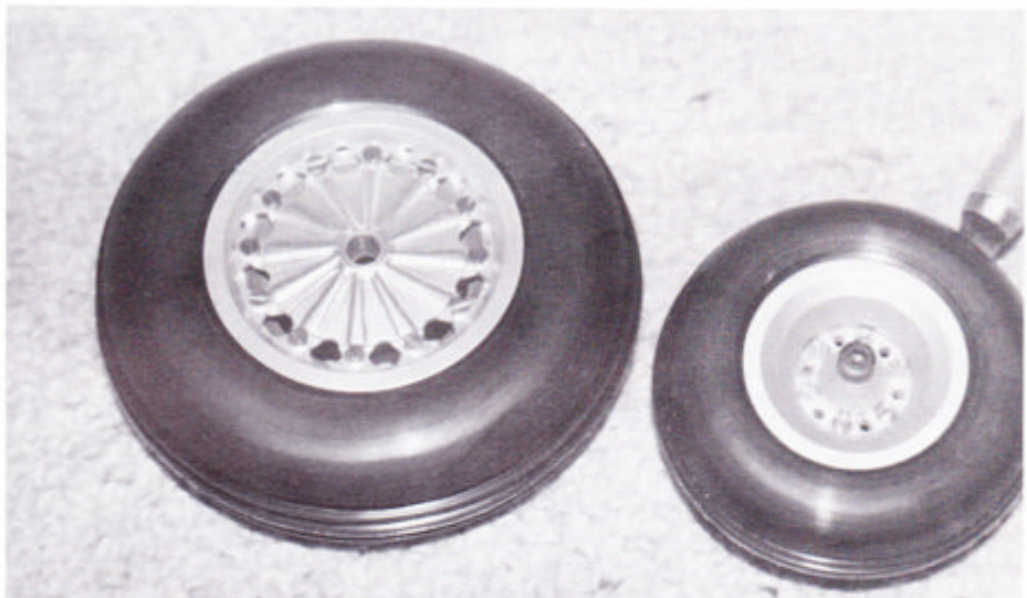
Håndlavede fælg med påmonterede dæk til bugstel og næsehjul.
