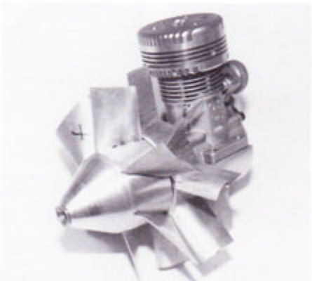
O.S. 77 monteret med rotor og stator.
