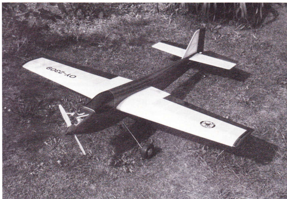
Modellen, som blev anvendt til fail-safe forsøg. Miniservo i hver vingehalvdel for at anvende FC-18 til differentieret flapperon funktion samt kobling af flaps og højderor til »firkant« manøvre. Egen konstruktion. Motor OS 25 FSR. Vægt 1700 g. Nu ødelagt ved rygflyvning i meget lav højde i turbulent vejr. Modtager og servoer var uskadt, men uheldet viser, at den menneskelige faktor altid er til stede uanset teknikkens kvalitet!
