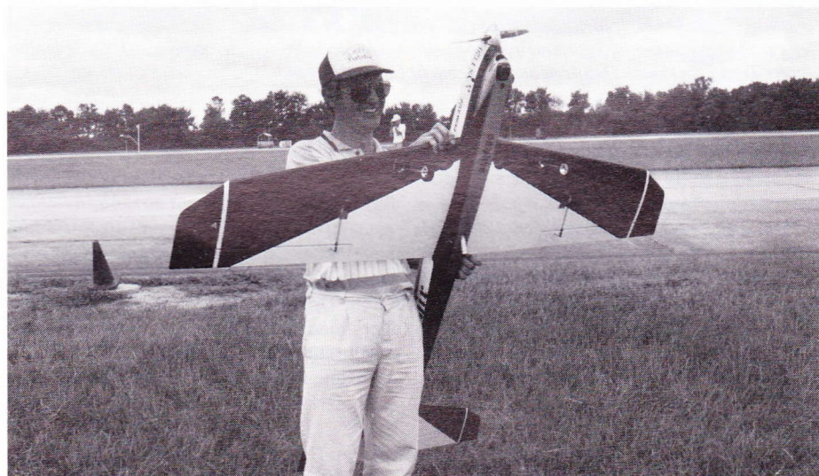
Nr. 2 blev Wolfgang Matt fra Liechtenstein med en selvkonstrueret »Saphir«, der er en videreudviklet Joker med en YS firetakts motor på 20 ccm med Hatori tuned pipe.
