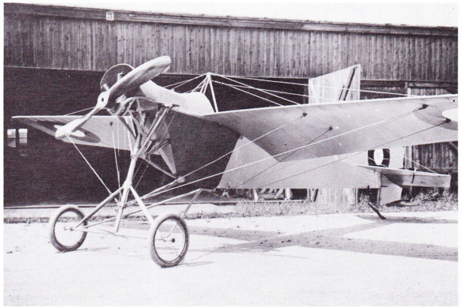
B&S-III, der blev den endelige udgave, fik en trekantet krop. På billedet ses wirene til vingevridningen tydeligt.
