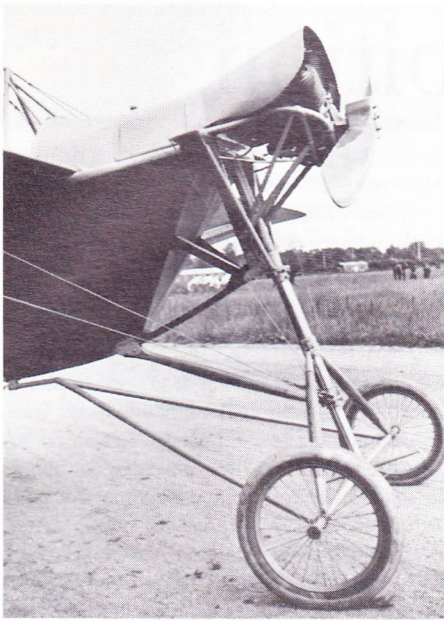
Flyets specielle understel set fra siden. Det er fjedrende ved hjælp af et hydraulisk system og i virkeligheden forud for sin tid, og det gav Berg & Storm flyet en helt egen profil.
