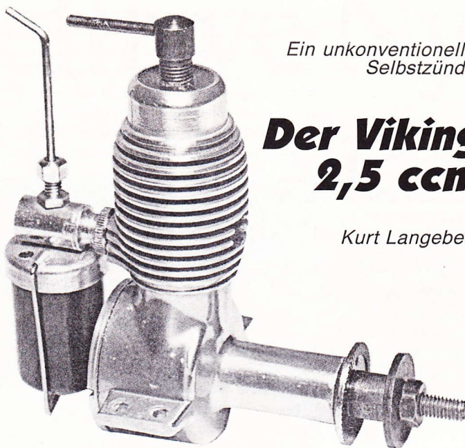
Ansicht des Viking 2,5 ccm Selbstzünders: beachtenswert der vorn liegende Auspuff
