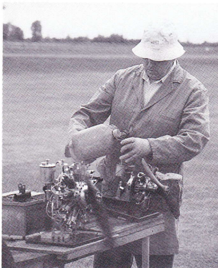
Motoren til højre er en hjemmebygget roterende stjernemotor på ca. 50 cm 3 til en kvartskala Sopwith Pub.
