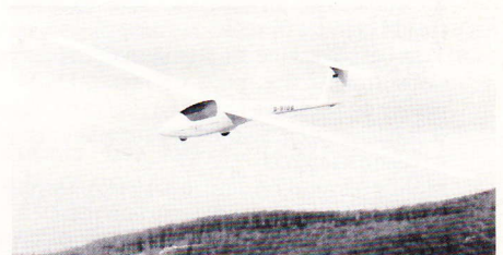
ASK 23 Semiskala model med Rhönflügel og Epoxykrop. Spændvidde 3200 mm.
