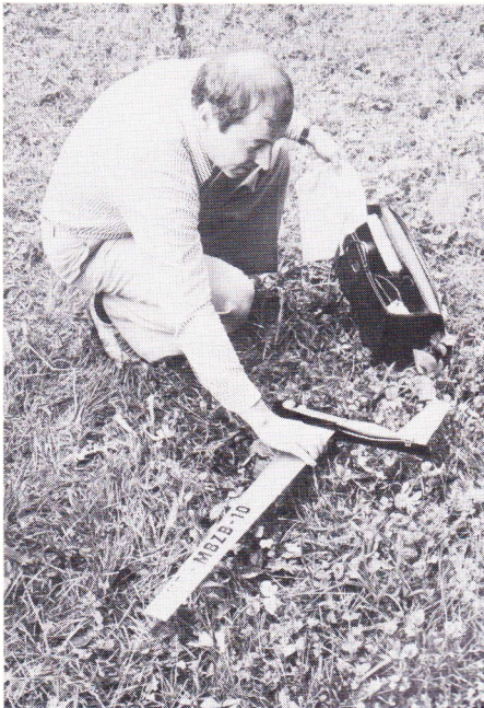
F2A – speedmodel. Louis Bilot med en typisk F2A speedmodel med en 2,5 ccm motor, der kan bringe hastigheden op på 280-310 km/t.
