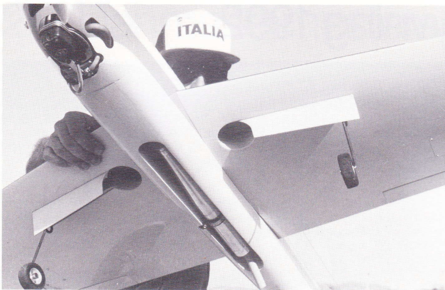
Kombinerede bremse/lukkeklapper på Pietro Favillas model. En fiks detalje.
