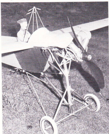
De mange stivere og barduner i understellet ses tydeligt på dette billede.
