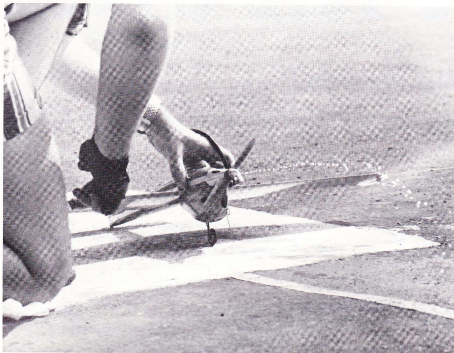
Overløbet fra tanken skal være uden bobler.
