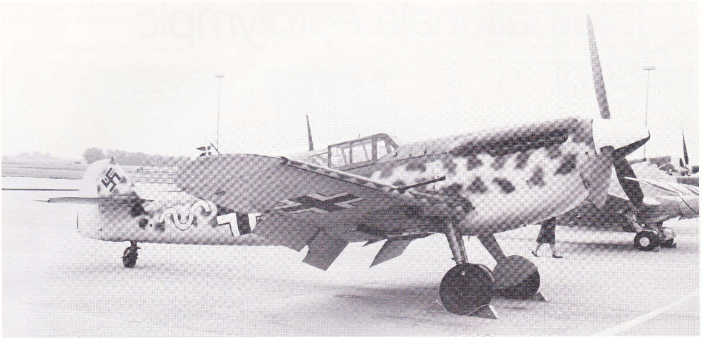
Den lidt usædvanlige næse på Messerschmitt'en afslører, at flyet er udstyret med en Merlin motor i stedet for den originale Daimler-Benz.
