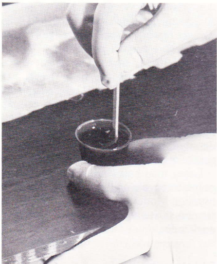
Efter idrypning af hæder er det vigtigt at røre godt rundt i polyestern.
