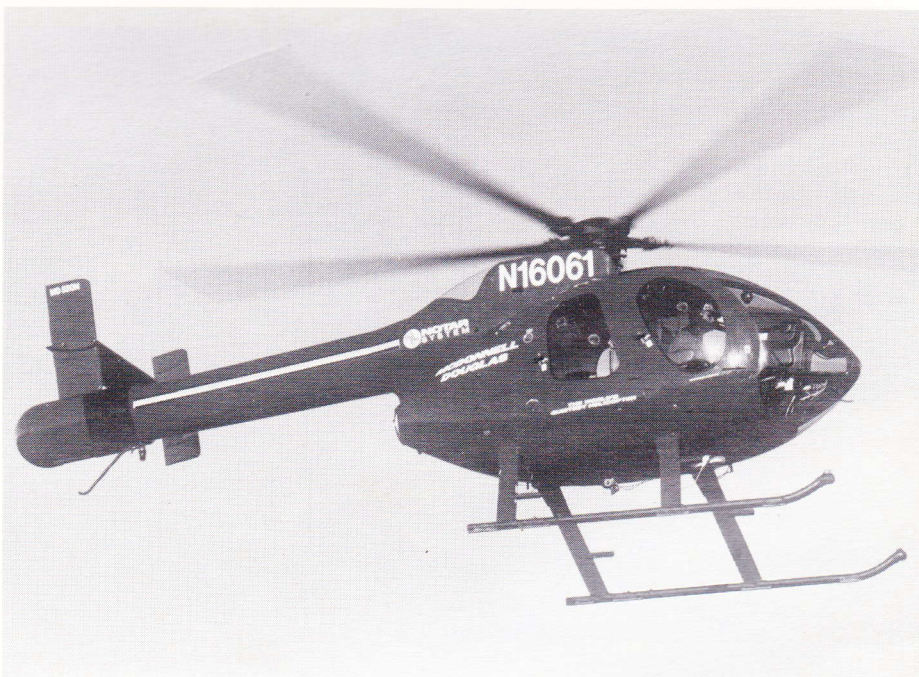
NOTAR hedder de nyeste helikoptere fra McDonnell Douglas til efternavn. Det står for No Tail Rotor – Ingen Halerotor – og denne revolutionerende konstruktion er blevet betegnet som det største fremskridt inden for helikopterteknologien, siden denne type luffartøjer blev til.
