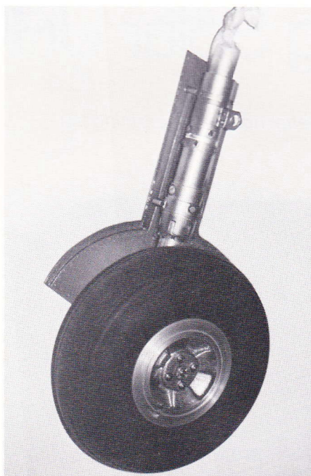
Venstre hovedhjul. Optrækningsvinklen blev øget til 96 grader.
