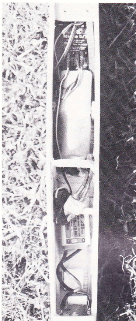
T.v. Trods den ringe størrelse er der god plads til modtager, batteri og switch.
