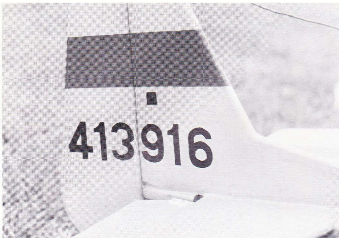
Bag den lille rude, der er lavet af transparent Salor-film, sidder pæren, der ved hjælp af elektronik fra ECA blinker, når anlægget er tændt. Blinkene kan ses i dagslys, men effekten er specielt flot i tusmørke.
