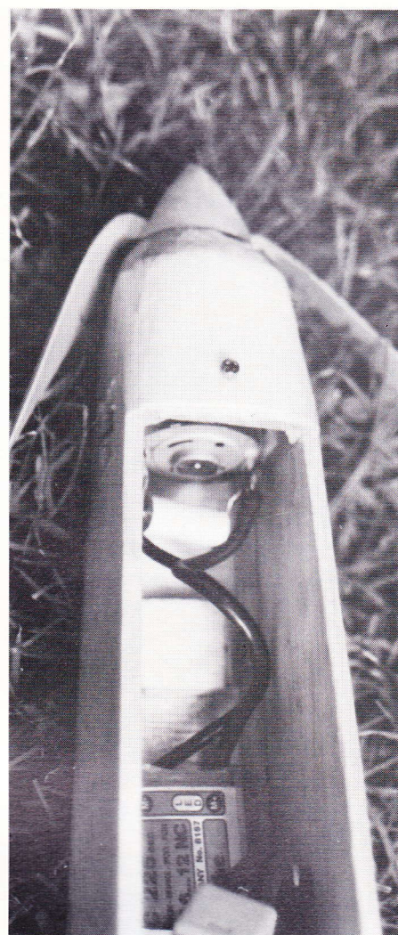
T.v. Trods den ringe størrelse er der god plads til modtager, batteri og switch.
