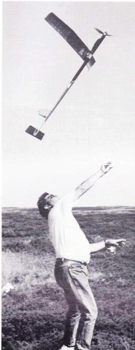
Jens Kristensen starter sin F1B model med et voldsomt kast. Propellen er endnu ikke begyndt at rotere, da modellen er forsynet med forsinket propelstart, så motoren først bruger af sin energi, når kastet ikke accelererer modellen længere.
