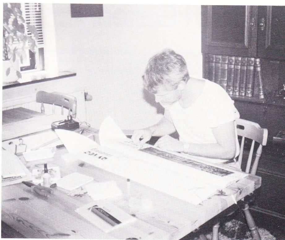
Panel nr. 1 er ved at være klar og sammenloddet med de ledninger, der er indbygget i vingen.
