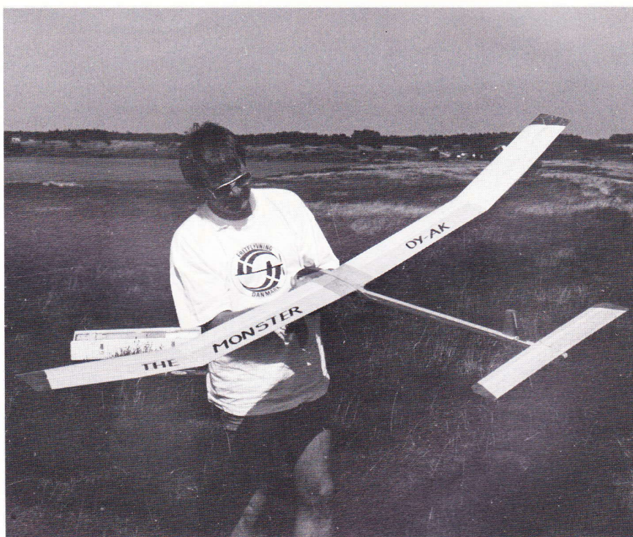
Det kan anes, at der er STEPPED TURBULATOR på vingens overside. Den har dog også turbulens-tråd på forkanten.
