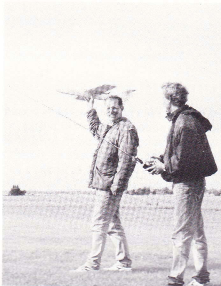
Med hjælp fra Ole Jørgensen er Jørgen Nielsen fra Thy RC Klub klar til jomfruflyvning med sin Mini Jet, der er bygget efter en tysk tegning. Modellen, der har en spændvidde på 90 cm, er udstyret med 7 x 1700 mha akkuer og 2 stk. Speed 400 6v motorer med hver sin afkortede (ca. 11,5 cm) Speed propel 6x5,5. Det er en velflyvende 2-motoret model. (Fotos: Jan Abel)
