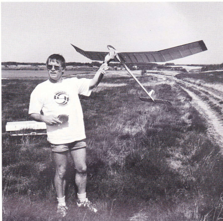
FF-redaktøren holder Anders Korsgaards DRAGONFLY. Man kan tydeligt se de udvendige ribber, som holder vingen i profilform.
