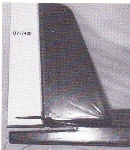
Claus har brugt en skrue til at holde sit haleplan på plads under flyvningen. Bagest kan man ane stødstangen, der bliver monteret på højderorets horn. (Fotos: PNM)
