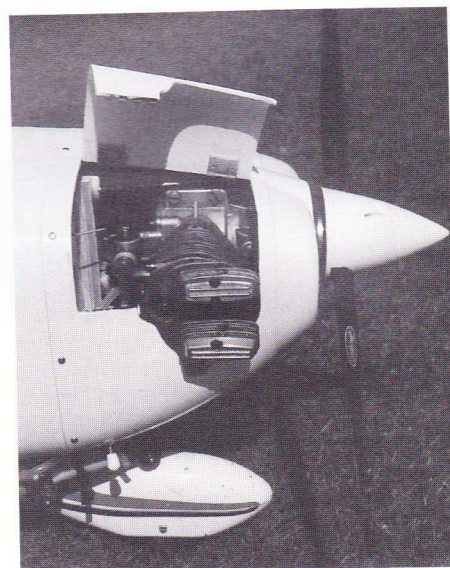
Motoren i den flotte Cessna Cardina er en OS 120 FS.
