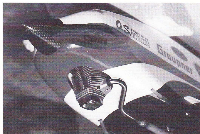
Nærbillede af motorinstallationen på Cranfield A-1: en OS 120 SP med Supercharger.
