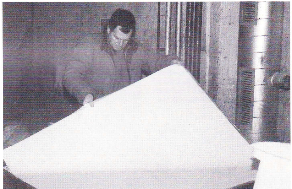
Øverst ses Preben med en skumvinge, og nederst er det Jørgen, som er i gang med at beklæde en vinge med glaslaminaten.
