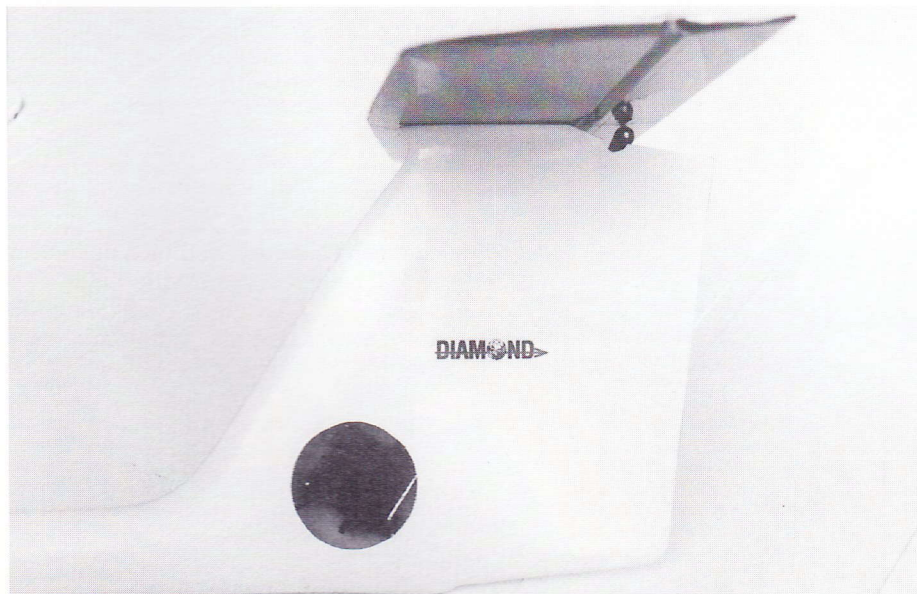
Bag dette hul i halefinnen sidder en mikroservo, der trækker højderoret.
