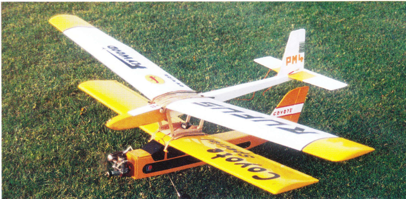
En 2-m svæver på ryggen af en almindelig trænermodel med en .35 motor er et fint par til flyløft.
