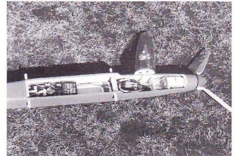
▲ En Cox motor kan trække en Spirit til vejrs - men det både larmer og sviner, En almindelig Spirit kan dog let bygges om til el. Her har Carsten Bantz været i gang. ▶
