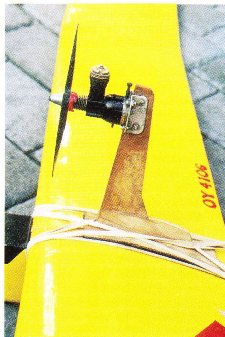
En motoropsats er hurtigt bygget.
