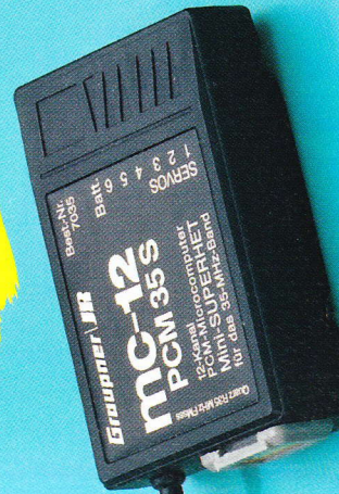
MC-12 PCM 6-kanals PCM-microcomputerstyret smalbåndsmodtager Best.nr. 7035 for 35 MHz-båndet Best.nr. 7040 for 35 MHz-båndet
