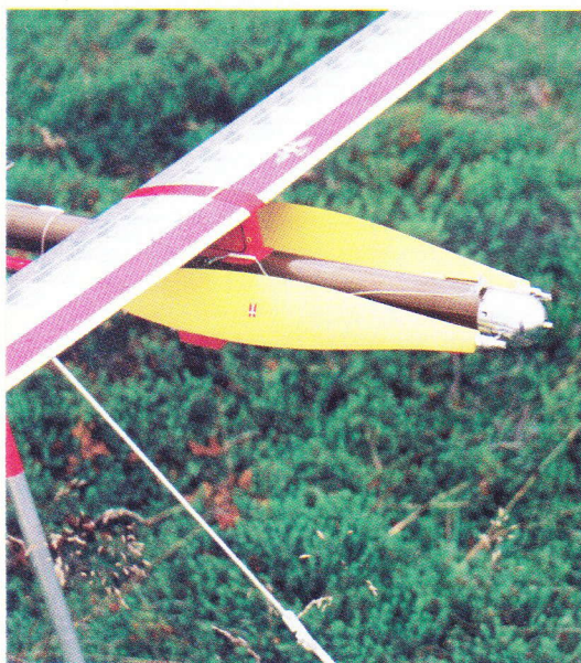
Modellen klar til at blive trukket op. De tynde striber på vingerne – der er fem – er ekstra turbulatorer, som hjælper den forreste turbulator til at give den rigtige luftstrøm og dermed opdrift på de smalle vinger.
