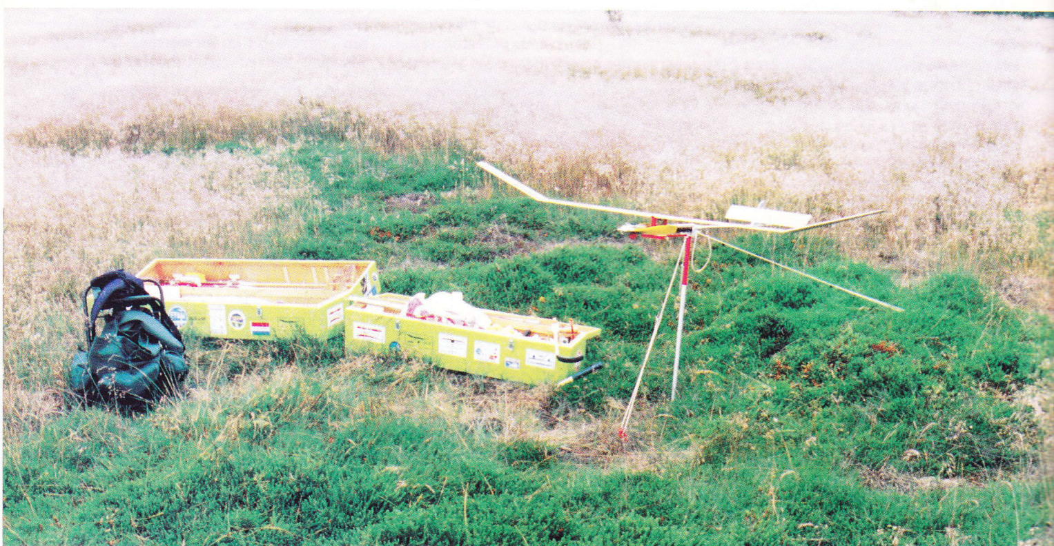
Modellen klar til at blive trukket op. De tynde striber på vingerne – der er fem – er ekstra turbulatorer, som hjælper den forreste turbulator til at give den rigtige luftstrøm og dermed opdrift på de smalle vinger.
