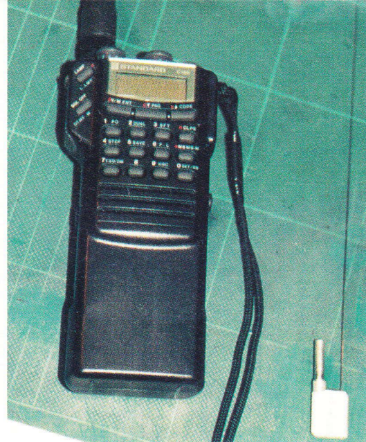
Springssystemet med den lille sender og Walkie-Talkie. Senderen har en 0,5 x 30 cm lang antenne og vejer med batteri 3,4 gram. Den har en rækkevidde på mange kilometer i luften og fire-fem hundrede meter, når modellen ligger på jorden.
