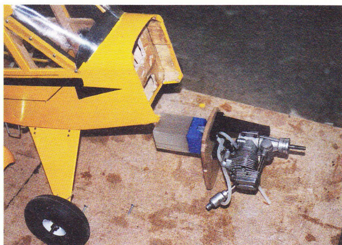
Forbrændingsmotorspant med motor og tank tages af, og med fire skruer monteres Piper Cub'ens faste motorspant. (Fotos: PNM)
