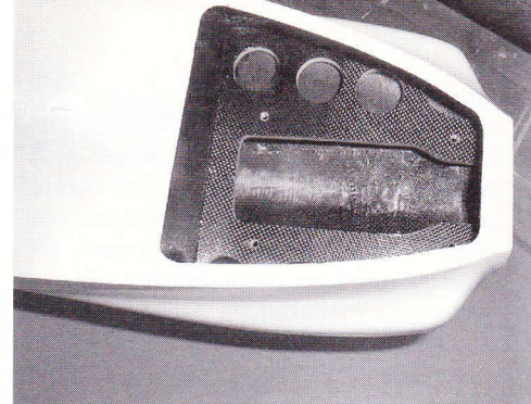
Motorpladen er af 6 mm krydsfiner med pålagt kulfibervæv. Brandskottet er 5 mm balsa med kulfibervæv på begge sider.
