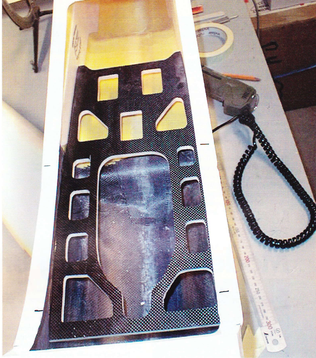
Servobrættet udskåret og monteret i kroppen. Vægt: 25 g.
