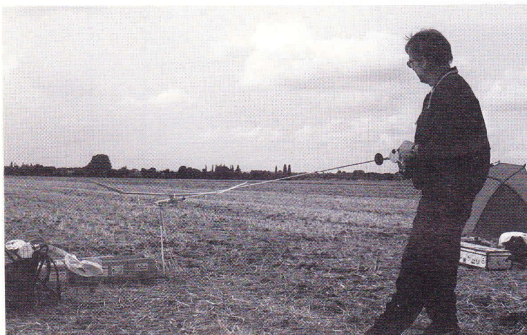
13. Motoren trækkes så langt ud, som man kan eller tør(!) under den første halvdel af optrækket, hvorefter man langsomt går ind mod modellen, mens de sidste omdrejninger tilføres. Bemærk, at momentmåleren er sat direkte til boremaskinen.
