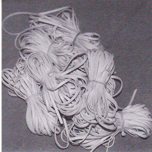
2. Et bundt færdigt afvejede motorer på 34 gram hver. En enkelt elastik er lagt omkring for at holde styr på spaghettien.
