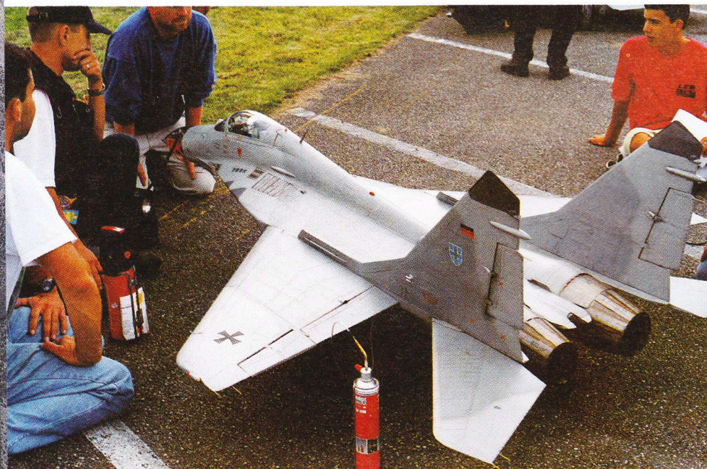
Vindermodellen, Wolfgang Klühns MiG-29 med to turbiner og en cirkavægt på 20 kg.
