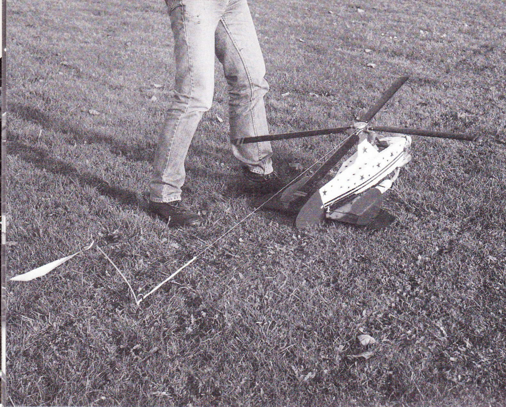
Starttrissen trækker rotoren op i omdrejninger. Efter 1\frac{1}{2} m er der så meget luftmodstand på rotorbladene, at omdrejningstallet næsten ikke stiger mere. Derfor skal det prøves at gøre trissens diameter større. Det eneste problem i det er, at det så bliver lidt sværere at slå bladene ud efter transport.
