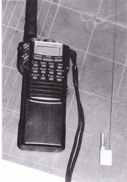
Den lille sender – ca. 3 gram – med batteri og antenne klar til montering i modellen samt walkien til springen (og lokal snak!)
