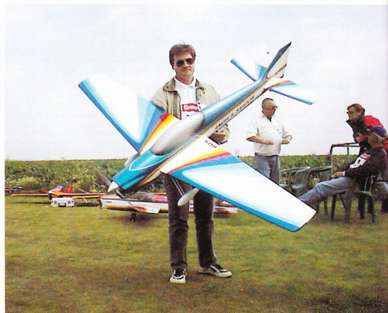
Russeren Vladimir Kozlovski med sin Angel Shadow, som han selv har designet og bygget. Det er en fuld komposit-model, færdigmalet fra formen.
