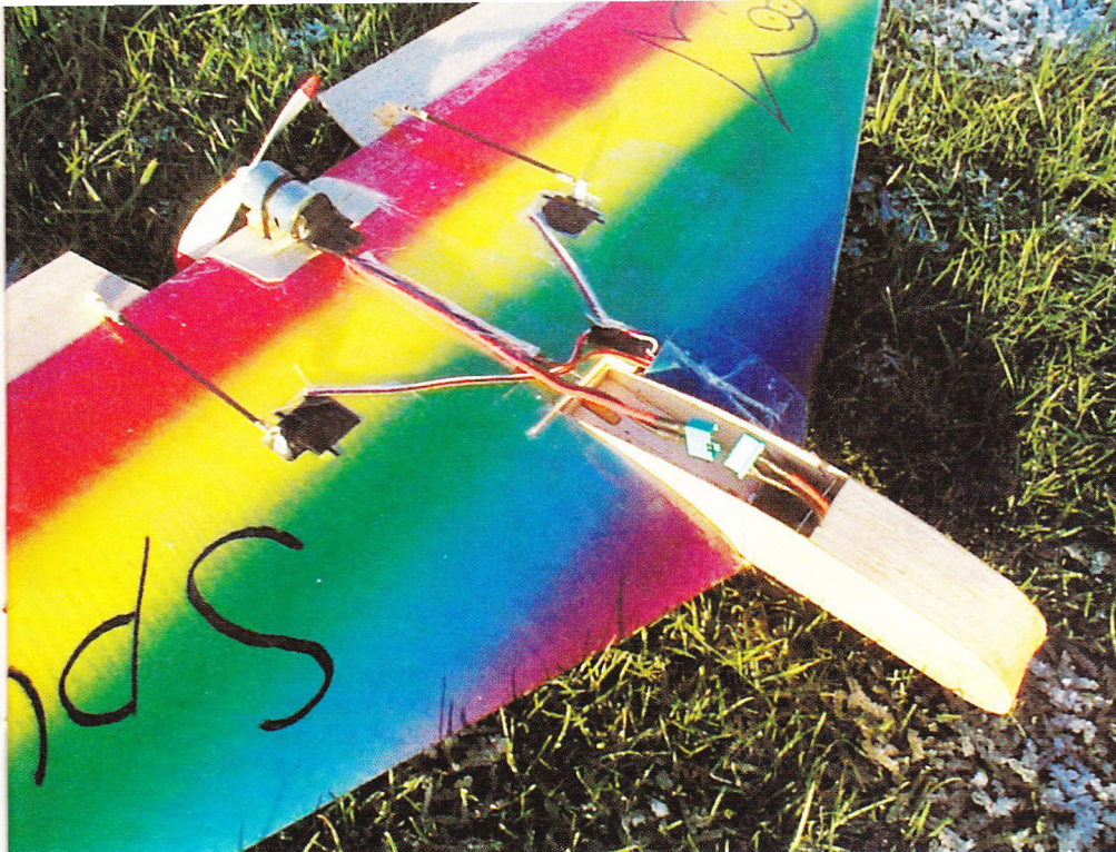
Tæt på motor-, servo- og radioinstallation.
