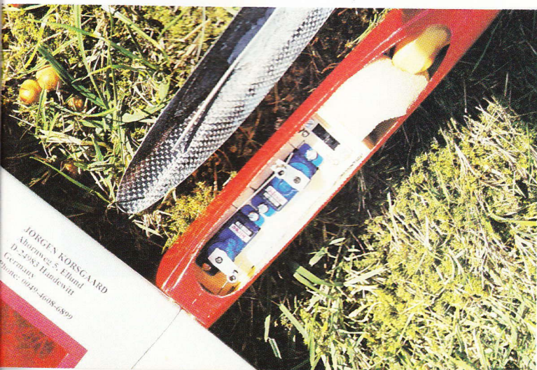
Et kig ind i "cockpittet" med mikroservoer. Canopiet er kulfiber.
