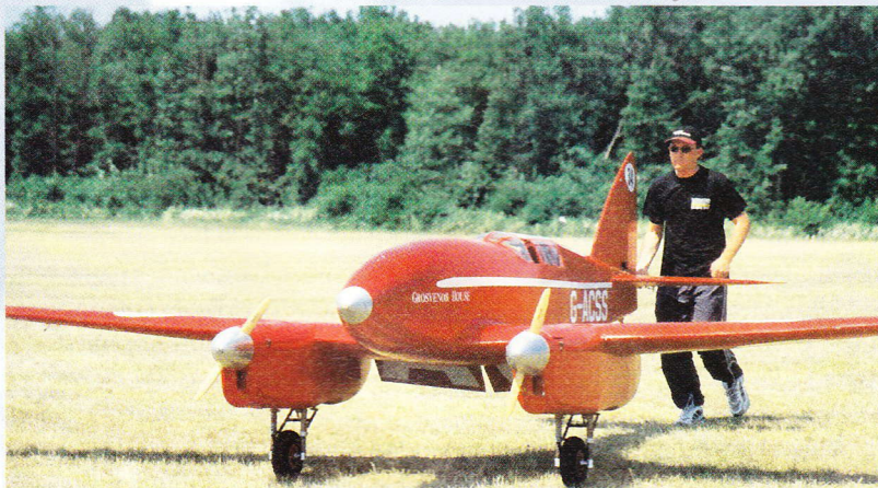
Tv: Steve Hollands DH86 Comet med en spændvidde på 6,8 m. 2 stk. Titan 74 motorer, vægt 68 kg. Skala 1/2, 12 servoer og Futaba radio.
