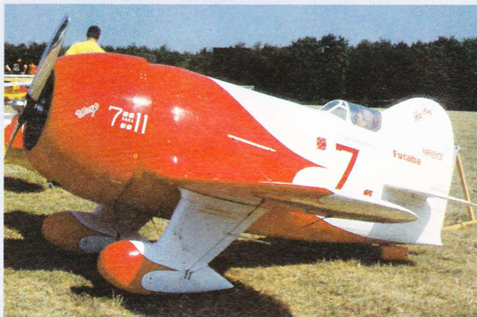
En Gee Bee R2. Spændvidde 3,8 m, 280 cc Limbach motor, vægt 55 kg, skala 1/2, 8 servoer, 3 akkuer, Futaba 1024.
