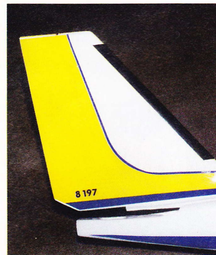
Figur 1B: Den sorte afiser er blot et stykke rektangulært folie, og monteret efter anvisningen vil over- og underkant sidde vinkelret på forkanten. Det kunne en italiensk designer aldrig finde på, så frem med kniv og/eller saks. Kanterne skal selvfølgelig flugte med finnens over- og underkant.
