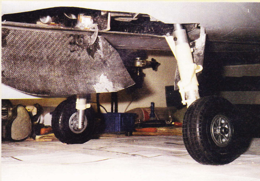
1 - Hovedhjulene skal rotere 90 grader, når de slås op
