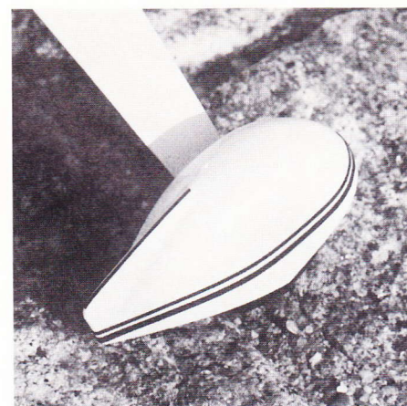
Fig. 6. Min model kører fint på selv et langhåret græstæppe, men går uhjælpeligt i stå på områder med et par cm. mos, idet hjul/kåber synker igennem.
