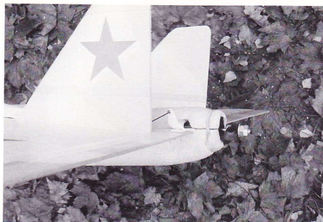
Halen er rundet af, for at få bedre luftstrøm forbi propellen.
