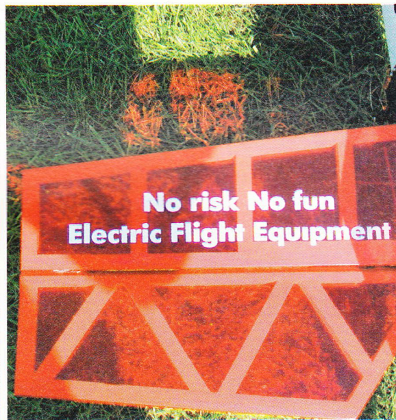
Bemærk storelsen af højderoret i forhold til resten af haleplanet. Fotograf: Flemming S. Nielsen
