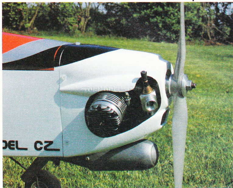
Motorinstallation. Der er valgt en installation hvor Webra'en hænger strået ned ad. Fotograf: Flemming S. Nielsen
